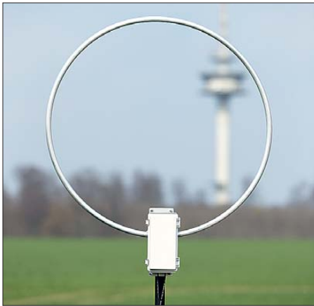
Bild 1: Rahmen und Verstärkergehäuse sind wetterfest für den Außenbetrieb konzipiert.
