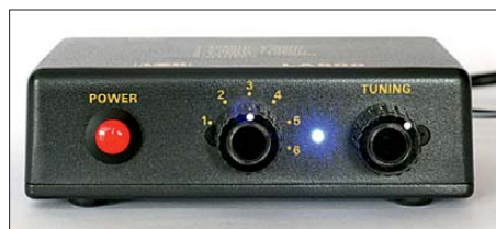
Bild 3: An der Kontrollbox wählt man den gewünschten Frequenzbereich und stimmt ggf. per Drehknopf aufs Signalmaximum ab.
