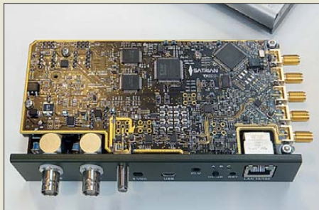
Das „Schweizer Messer“ für SDR: Ein Prototyp des bis in den Gigahertzbereich nutzbaren SDR-Transceivers TX8M aus Estland
