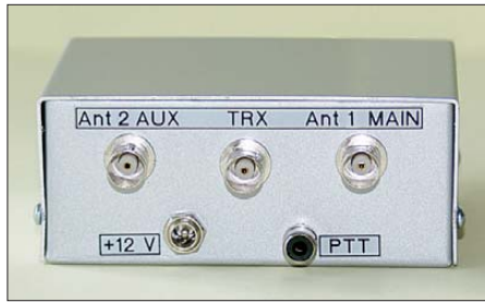
Bild 4: Gehäuserückseite des X-Phase II, hier mit BNC-Buchsen versehen; alternativ sind auch PL-Buchsen einsetzbar.
