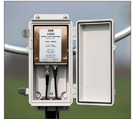
Bild 2: Bei geöffnetem Wetterschutzgehäuse sieht man die Verstärker- und Abstimmereinheit. Von unten werden das Antennen- und das Steuerkabel geschützt hineingeführt.
