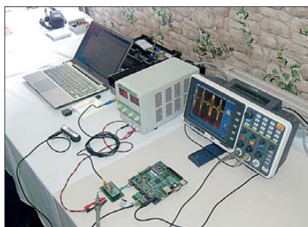
Test der bis 10 W nutzbaren PA von DM5KL am mitgebrachten Messplatz
