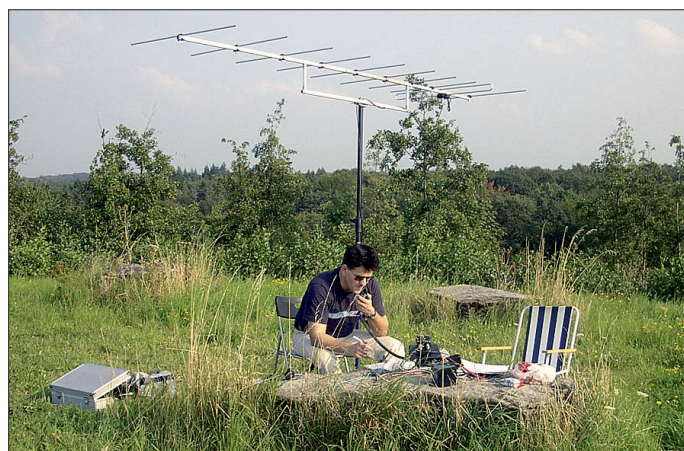
Bild 7: Bei Portabelbetrieb – hier im Bild der Autor – sitzt man oft nahe der Antenne. Probleme kann es geben, wenn die thermische Belastung die zulässigen Grenzwerte übersteigt.
