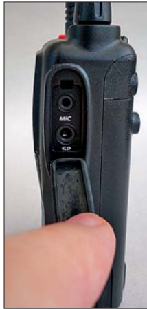
Bild 6: Eine massive Abdeckung schützt bei Nichtgebrauch die Klinkenbuchsen für Mikrofon und Lautsprecher vor Schmutz und Wasser. Das Gerät ist IP54-geschützt.
