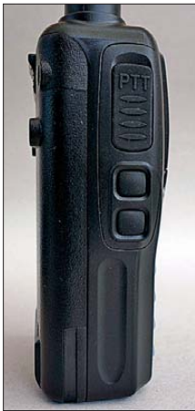
Bild 6: Eine massive Abdeckung schützt bei Nichtgebrauch die Klinkenbuchsen für Mikrofon und Lautsprecher vor Schmutz und Wasser. Das Gerät ist IP54-geschützt.
