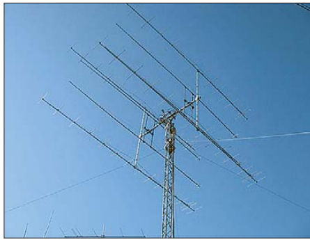
OH6KTL arbeitet mit vier 16-Element-Yagi-Antennen und etwa 400 W. Die Gruppe hat mit ihrer Fokussierung gegenüber nur einer Yagi-Antenne sicher auch zum Gelingen der QSOs mit CT1HZE beigetragen. Foto: OH6KTL
