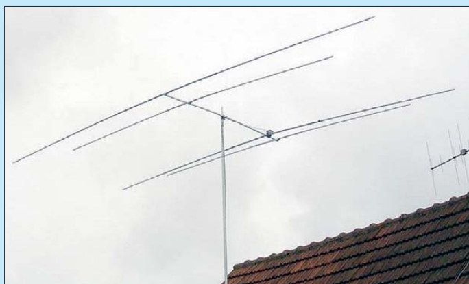
Bild 1: Ansicht des von ON8DM aufgebauten 2-Element-Beams für die Bänder 10 m und 15 m
