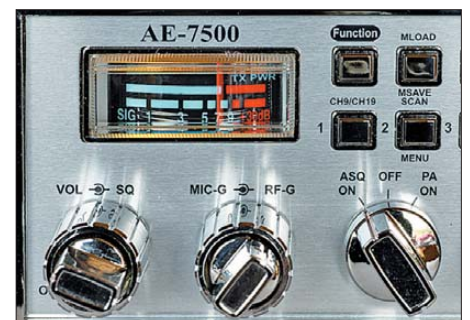
Ein analoges Zeigerinstrument dient u. a. als S-Meter. Wesentliche Einstellparameter sind direkt über Drehknöpfe zugänglich. Fotos: DL1ABJ
