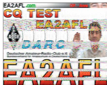
Bild 10: Zur Demonstration seiner Wirkung wurde das Gerät mehrmals kurz ausgeschaltet, wodurch die mit einem S9-Störsignal unleserlichen weißen Farbbereiche des SSTV-Signals wieder als weiße Streifen erkennbar sind.
