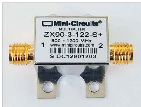
Bild 10: Mini-Circuits-Frequenzverdrehfacher vom Typ ZX90-3-122-S+ im Metallgehäuse mit SMA-Steckverbindern
