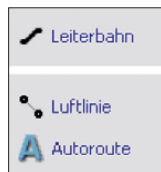
Bild 3: Die Buttons der Werkzeuge Leiterbahn , Luftlinie und Autorouter befinden sich in der linken Werkzeugleiste.
