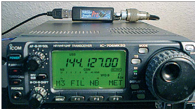
Bild 1: Das SDR FUNcube-Dongle Pro+ und der Transceiver Icom IC-706MKIIG in trauter Eintracht; an der richtigen Stelle angeschlossen bleibt der FCDPP auch im Sendebetrieb vor zu hohen Spannungen geschützt.
