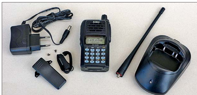
Bild 2: Zum Lieferumfang des DJ-A10E zählt auch eine Ladeschale mit Steckernetzteil. Laden lässt sich das Gerät nur in dieser Schale.
