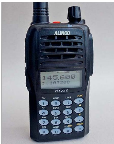
Bild 1: Die Tastatur wird bei Bedienung hellweiß durchleuchtet, das Display wahlweise bernsteingelb, violett oder blau beleuchtet.
