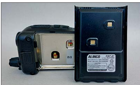
Bild 7: Mit einer Kapazität von 1,5 Ah unterstützt der Akkumulator langen Funkbetrieb.
