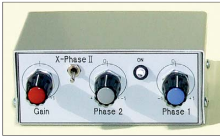
Bild 3: Die fertige X-Phase II mit 14-mm-Spannungsdrehknöpfen; größere Knöpfe erlauben eine einfachere Bedienung.
