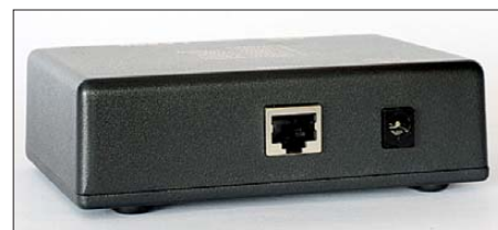
Bild 5: Auf der Rückseite der Kontrollbox liegen Anschlussbuchsen für die externe Stromversorgung und das Steuerkabel. Fotos: DE8JOI
